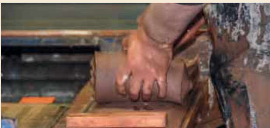
Ein Lehmklumpen wird in eine nasse Form gegossen. Der Lehm wird angedrückt und überschüssiges Material entfernt. Wenn der Handstreich die Form anhebt, gleitet der geformte Lehmklumpen – mit Wasser als Gleitmittel – aus der Form auf eine Unterlage.
