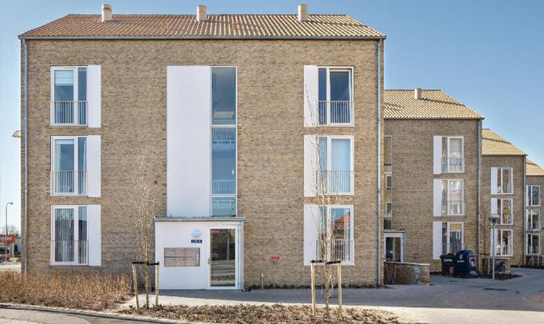
Die markierten weißen Fenster- und Türpartien der neuen Gebäude lehnen sich an die Form der ursprünglichen Häuser an, wurden jedoch in einer zeitgemäßen Formensprache ausgeführt. Die Steine der Fassadenmauern wurden ausschließlich mit der Kopffläche nach außen vermauert, ein Detail, das von einem der ursprünglichen Wohnblöcke stammt.
