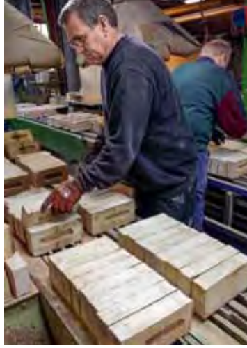
Sechs bis sieben Mitarbeiter kontrollieren und mischen bei Petersen Tegl täglich die Steine, ehe diese palettiert, verpackt und versandt werden. Fotos: Thomas Mølvig
