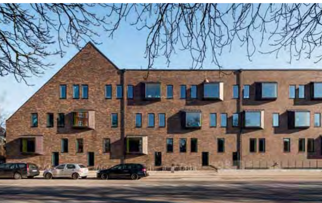
Die Höhe der Gesimse und die Fassadenlinie des neuen Gebäudes folgen denen der alten Schule, während das Dach am Nordende des Gebäudes eine markante Fase aufweist.
