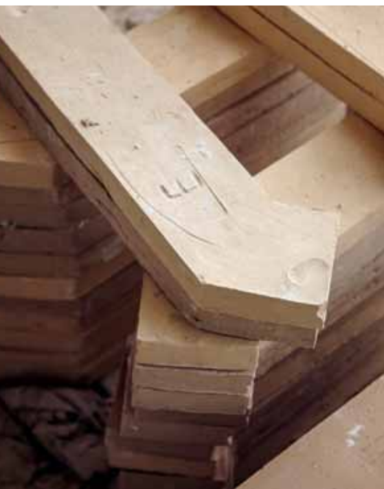
Zur Lösung der zahlreichen anspruchsvollen Teilaufgaben wurden insgesamt 85.890 Kolumba-Steine in 27 Sonderausführungen hergestellt. Mit industriell gefertigten Steinen wäre dies nicht möglich gewesen.
