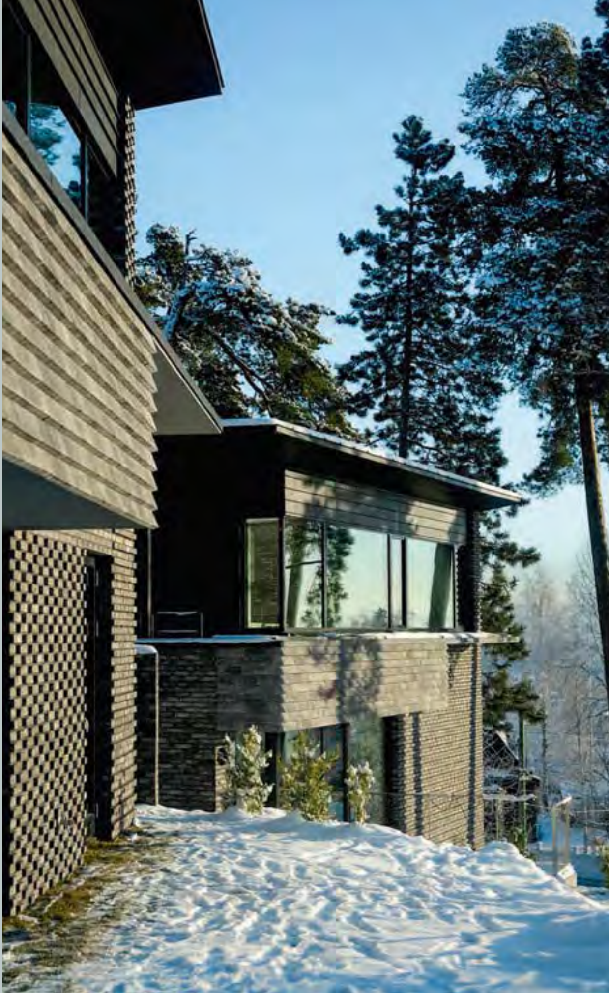
Für die Anlage auf dem kuppigen Gelände wurden kohlegebrannte D-Steine für die Fassaden und ein Fassadenziegel vor den Balkons verwendet, um diese als leichteres Fassadenelement zu betonen. Das Farbenspiel beider Steine changiert in Grautönen.
