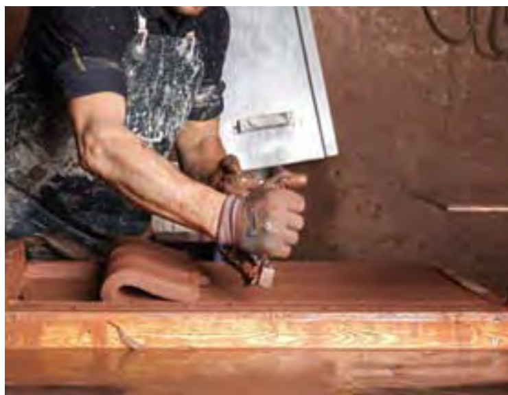
Die 15 kg schweren Cover-Stein sind handgefertigt. Die Architekten, der Bauherr und die Ziegelei waren erst nach vielen Versuchen mit dem fertig gebrannten Ergebnis zufrieden.
