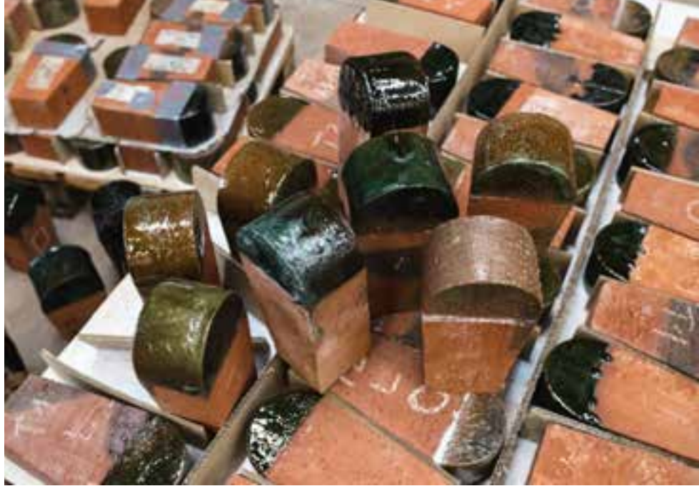
Die handgefertigten Steine vor dem Abtransport aus der Ziegelei. Nur der sichtbare Teil der zungenförmigen Steine wurde glasiert um zu sichern, dass der Mörtel die Ziegel bindet.
