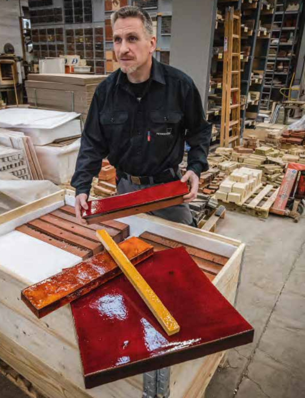
Erich Mick, Leiter der Abteilung für Spezialsteine bei Petersen Tegl, und sein Team produzierten insgesamt 1700 glasierte Ziegel für die Eingangspartie. Foto: Anders Sune Berg
