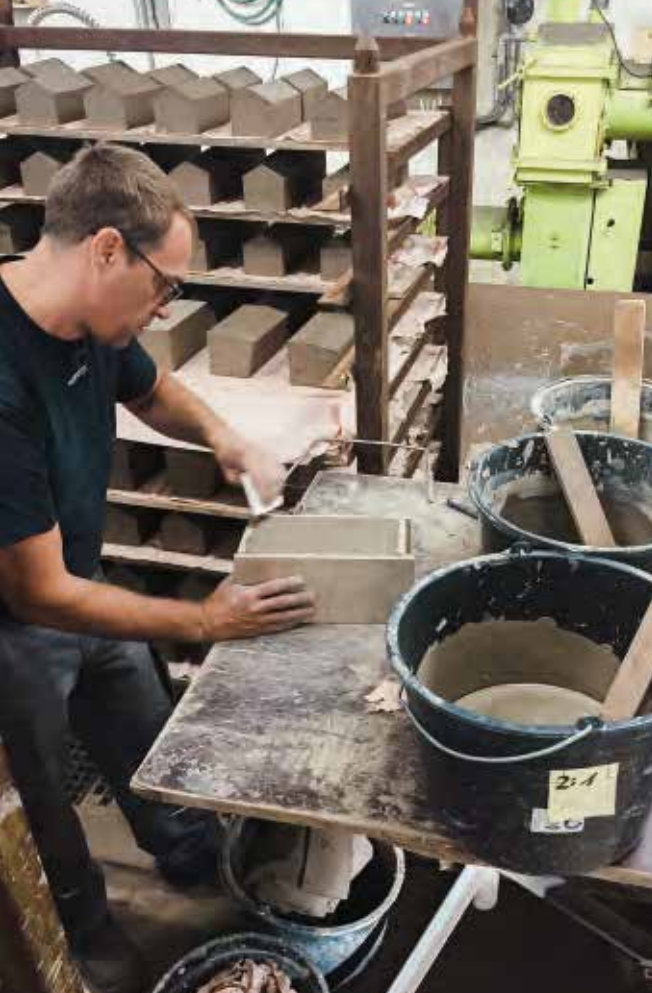
Etwa die Hälfte der Produktion von Petersen Tegl, auch die Formsteine für das Museum De Lakenhal, werden in der Ziegelei in Broeger von Hand geformt – nach mehrere hundert Jahre alten Verfahren.
